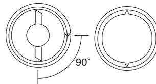
工具がインサートに引っかからない場合は、ヤスリで図右側の様にキズを付けてください。
